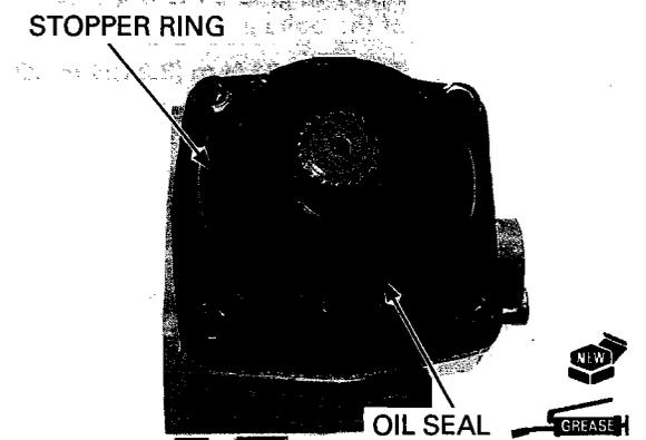
OUTPUT DRIVE GEAR ASSEMBLY
