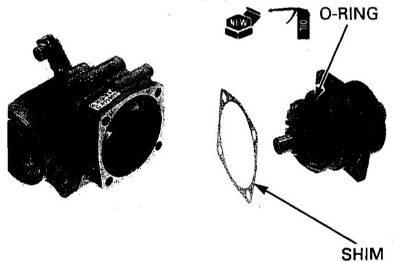
**OUTPUT DRIVE GEAR DISASSEMBLY**
